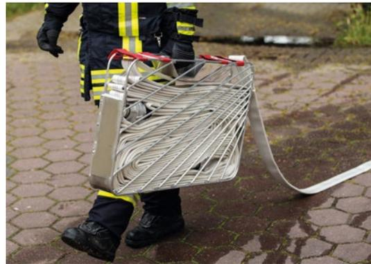
Am Einsatzort (Rauchgrenze, Haustür, Treppenraum) den flexattack® Tragekorb auf die Seite legen und aufklappen. Die restliche Leitung im Schlauchtragekorb kann nun herausgeschoben werden. Der Schlauch liegt in geordneten Buchten am Boden. Diese dienen als Schlauchreserve.
