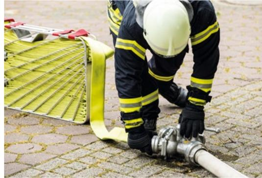
Durch die Bauform der Seitenwände können die Kupplungen nicht im Tragekorb verhaken. Die Kupplungen werden immer in Richtung Schlauchauslauf geführt.
